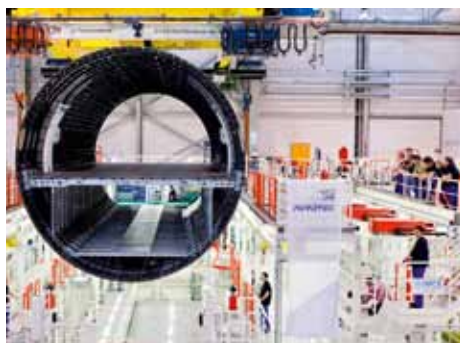
De nieuwe Airbus A350 WXB bestaat al voor meer dan de helft uit composiet, opgebouwd uit een oersterk en lichtgewicht laminaat op basis van carbonweefsels.
