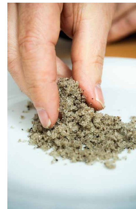
Struviet is niet alleen kostbare meststof, maar ook het bestanddeel in urine dat zich afzet op leidingwanden en zelfs pompen en kranen van de verwerkingsinstallaties kan blokkeren.
